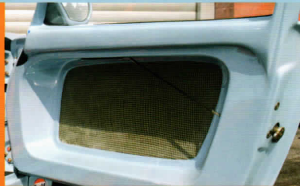
Die Türen wurden komplett abgespeckt
