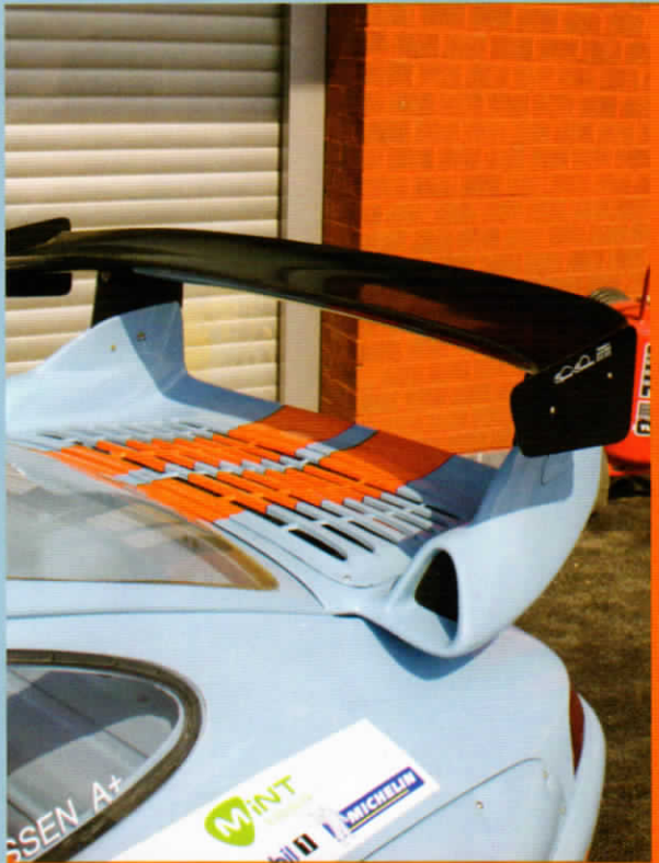
Fest stehender Heckflügel mit Aerodynamik-Leitwerk-Aufsatz
